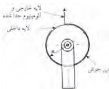
شکل ۴: نمای شماتیک نمونه برای آزمون جدایش لایه‌ها
