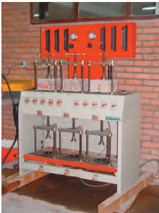
دستگاه تست نفوذپذیری تحت فشار آب طبق استاندارد EN 12390 Part 8 و DIN 1048 - بخش بتن
